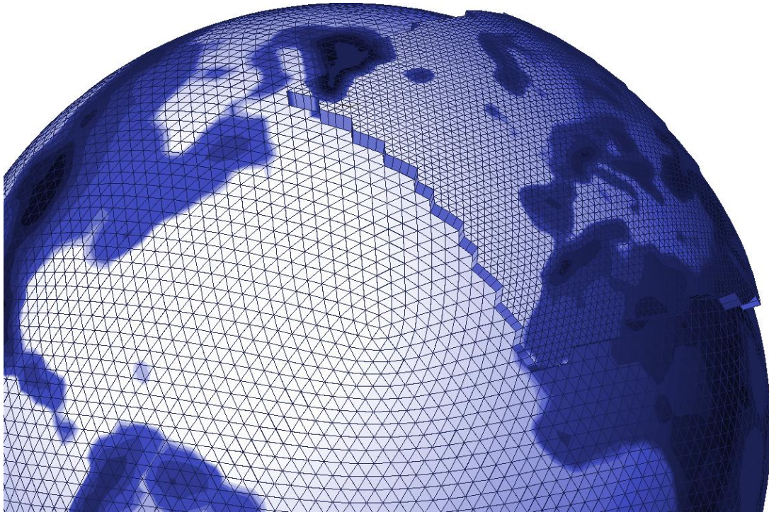
Abbildung 3: Darstellung des horizontalen Dreieckgitters des globalen ICON-Modells des DWD mit einer Verfeinerung des Gitters bzw. erhöhter Auflösung über Europa, [16, S. i]
