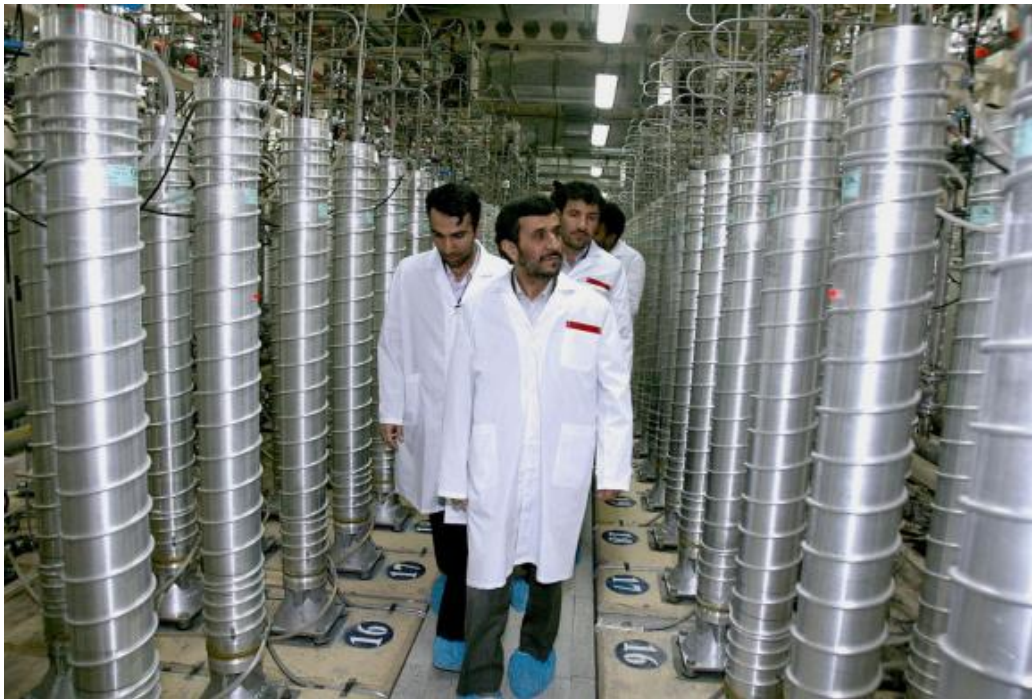
Abbildung 4: Urananzentrifugen in der iranischen Urananreicherungsanlage in Natanz (Quelle: http://www.upi.com )
