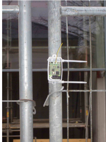
Abbildung 5.1: Befestigung eines Sensorknotens am Bauzaun
