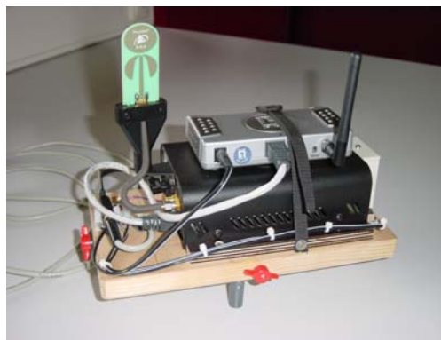
Abb. 5: UWB-Transceiver mit aufgesetzter WLAN-Bridge
