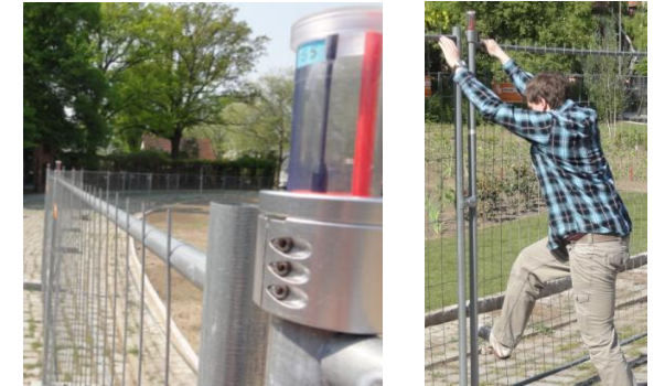
In den Zaun integrierte Sensorknoten erkennen Einbrüche
