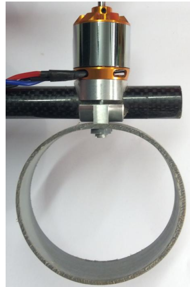
Abbildung 3.9.: Montierter Motor Der Motor, die Klemme am Arm und der Lande- fuß aus PVC-Rohr werden durch zwei Schrauben zusammengehalten.
