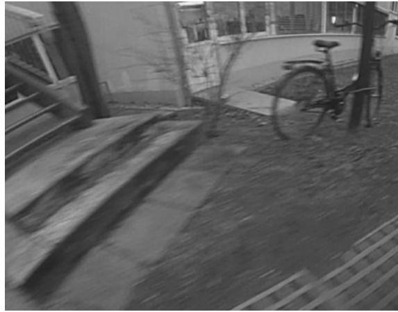
Abbildung 7: Aufnahme einer Fahrt mit schwacher Außenbelichtung. Dadurch ist die Belichtungszeit der Kamera so lang, dass, wie hier dargestellt, ein Verwischungseffekt schon bei geringen Geschwindigkeiten auftritt. Deutlich erkennbar ist dies bei dem Muster der Steine und den Stufenkanten.
