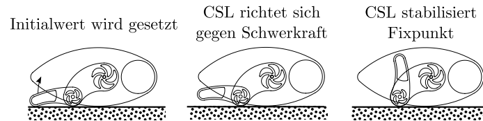
Abbildung 36: Abgebildet ist ein Beispiel für einen Bewegungsablauf, der durch das Verfahren zu Symmetriebrechung beim Umschalten von Release nach Contraction erfolgt. Links wird im stabilen Fixpunkt in den Contraction Modus umgeschaltet und der Integrator mit einem Initialwert gefüllt. Dadurch wird eine Bewegung induziert und die Schwerkraft fängt an dieser entgegenzuwirken. Dies führt dazu, dass sich der Contraction-Modus des CSL gegen die Schwerkraft richtet und den ehemals instabilen Fixpunkt stabilisiert.
