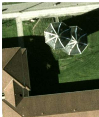
Abbildung 2.15: Der Double Mapping Effekt auf einem rektifizierten Foto. Die korrekte Größe des Hauses kann abgelesen werden, Teile der Umgebung werden jedoch verdeckt (Quelle [27]).
