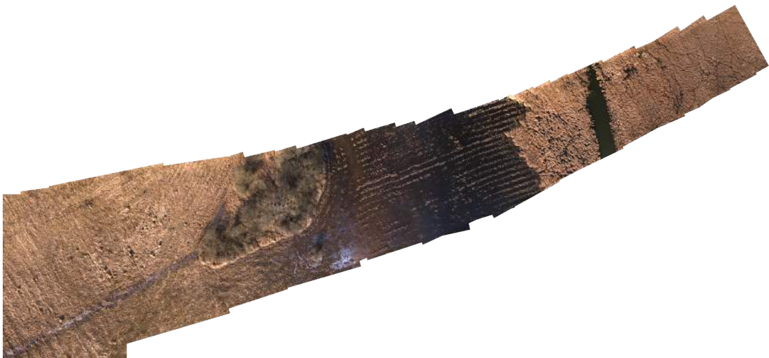
Abbildung 2.11: Beispiel eines sich aufschaukelnden Fehlers der Deltatransformation. Die Rekonstruktion startete in der linken unteren Ecke. Schon nach 24 Bildern ist die Größe des Bildes auf weniger als ein Viertel der ursprünglichen Größe geschrumpft, obwohl die Flughöhe nicht entsprechend stieg (Quelle: Institut Gewässerökologie und Binnenfischerei, Deutsches Zentrum für Luft- und Raumfahrt e.V./Optische Informationssysteme, HTW Dresden/Geoinformation, FU Berlin/ Institut für Weltraumwissenschaften).
