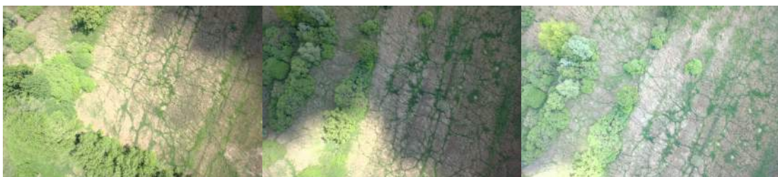
Abbildung 3.4: Drei überlappende Bilder, zeitlich kurz nacheinander aufgenommen und per kumulative Verteilungsfunktion gespreiztem Farbraum. Die lokalen Optima produzieren verschiedene Farben für dieselben Objekte (Quelle: HTW Dresden/Geoinformation, GEO-METRIK-Ingenieurgesellschaft mbH Magdeburg).
