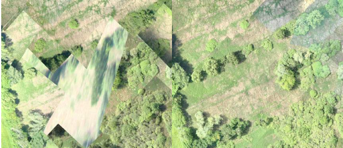
Abbildung 4.7: Vorher/Nachher-Vergleich der Mischung nach dem Nadirfehler. Links: Besonders stark verzerrte Teile überdecken Bereiche mit niedrigem Fehler. Rechts: Die Mischung der Bereiche dicht am Nadir liefert ein ansprechendes Ergebnis. (Quelle: HTW Dresden/Geoinformation, GEO-METRIK-Ingenieurgesellschaft mbH Magdeburg)
