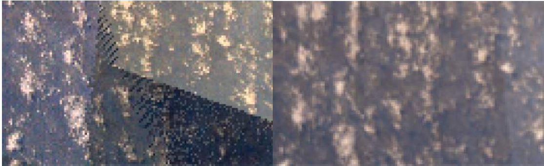
Abbildung 4.10: Vorher/Nachher-Vergleich des Randverhaltens beim Ausschluss über Z-Buffer. Links: Bröckelige Ränder und mehrdeutige Tiefenverhältnisse aufgrund der geringen Bit-Tiefe des Z-Buffers. Rechts: Die auf die geringe Bittiefe angepasste Fehlerfunktion erzeugt klare Ränder (Quelle: Institut Gewässerökologie und Binnenfischerei, Deutsches Zentrum für Luft- und Raumfahrt e.V./Optische Informationssysteme, HTW Dresden/Geoinformation, FU Berlin/ Institut für Weltraumwissenschaften)
