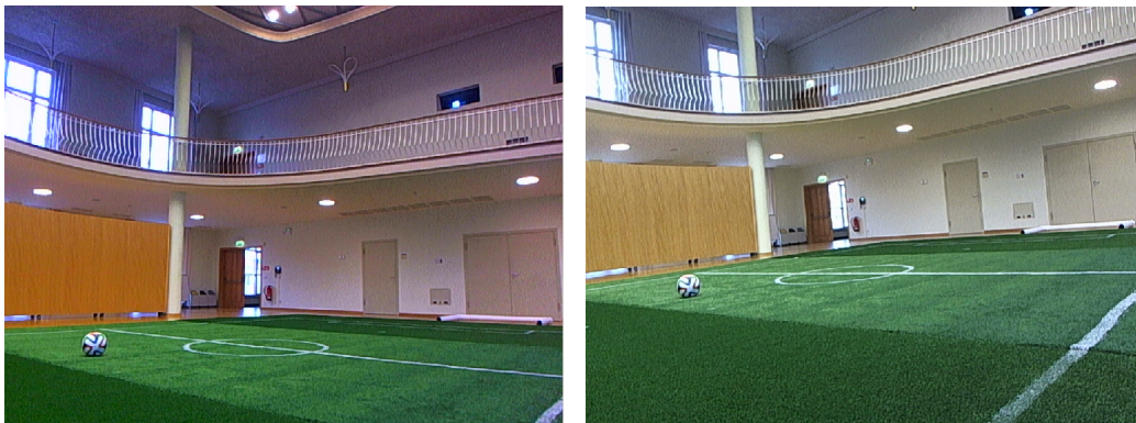
Abbildung 21: Helligkeitsunterschiede zweier baugleicher Kameras mit gleichen Einstellungen
