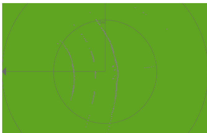
Abbildung 7: Die aus den Edgels gewonnenen Mittelpunkte der Spurmarkierungen
