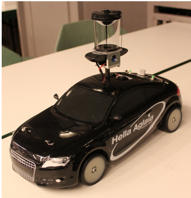
Abbildung 1: Das Modellauto mit der omnidirektionalen Kamera
