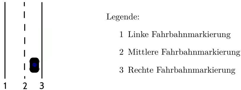
Abb. 11: Darstellung des Straßenverständnisses mit Positionen der Fahrbahnmarkierungen. Das Fahrzeug befindet sich in der rechten Fahrspur.
