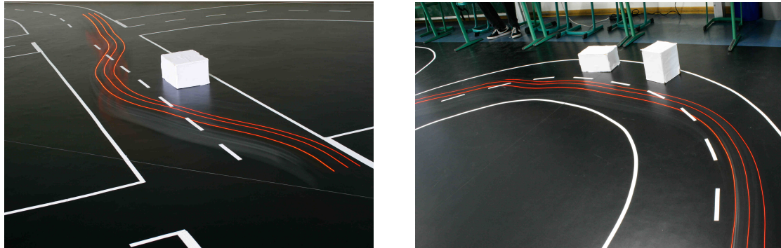
Abb. 21: Langzeitbelichtungsufnahmen während der Überholmanöver. Zur Veranschaulichung sind die Bremslichter dauerhaft eingeschaltet und ein Objekt auf der Fahrbahn aufgestellt, welches jedoch nicht erkannt wird. Fotos: Severin Junker
