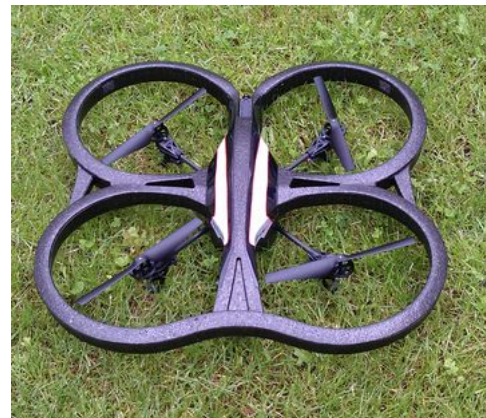
Abbildung 1: Standardaufbau eines Multicopters, hier vom Typ Quadrocopter. Abgebildet ist ein kommerzielles Produkt, die AR.Drone 2 von der Firma Parrot
