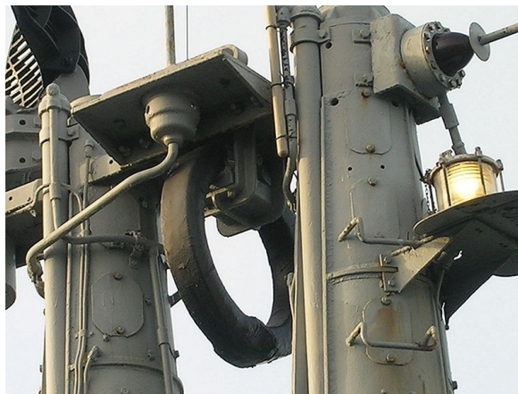
VLF-Empfangsantenne (Ring in Bildmitte) auf einem U-Boot
