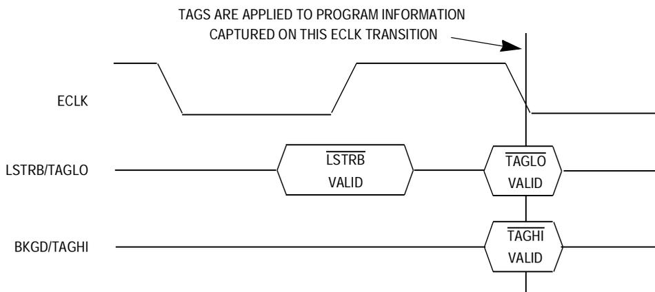
**Figure 8-6. Tag Input Timing**
