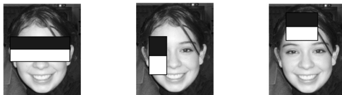
Abbildung 2.19: Beliebige Skalierung und Positionierung der Haar-like Features
