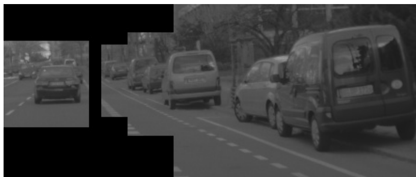
Abbildung 3.5: Vorauswahl reduziert das Eingangsbild auf relevante Bereiche
