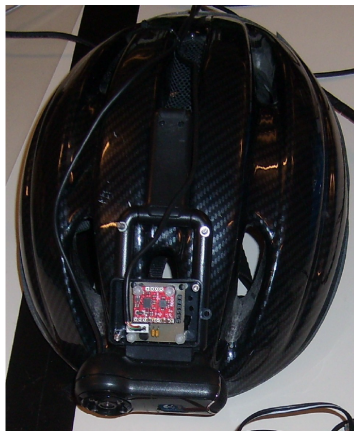
Abbildung 4.1: Erster Prototyp mit Kamera (Bildunterseite) und IMU (rot) auf einen Fahrradhelm montiert.
