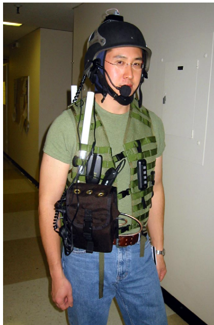
Abbildung 3.2: Tragbares System mit erweiterter Realität durch 3D-Audio-Informationen [15]
