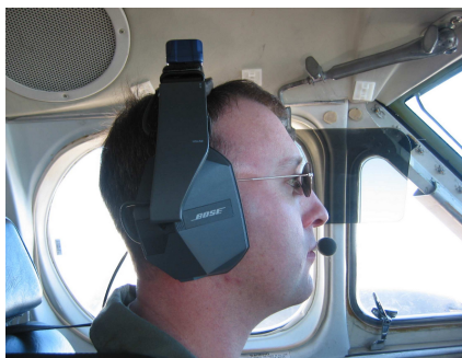
Abbildung 3.1: Pilot mit einer IMU an das Headset montiert (Kasten an der Oberseite des Headsets). [13]
