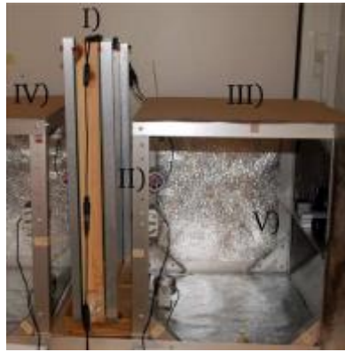
Abbildung 3: Beobachtungsstock. Auf der linken Seite befindet sich I) der Beobachtungsstock, der von einem Aluminiumrahmen umgeben ist. Davor sind die II) roten LED-Lampen angebracht, III) ist die rechte Seite und IV) die linke Seite des Beobachtungsstocks. V) Die Kamera ist vor dem Beobachtungsstock positioniert. Quelle: Wario et. al. (2015) Automatic methods for long-term tracking and the detection and decoding of communication dances in honeybees. Frontiers in Ecology and Evolution 3: 103, 3.
