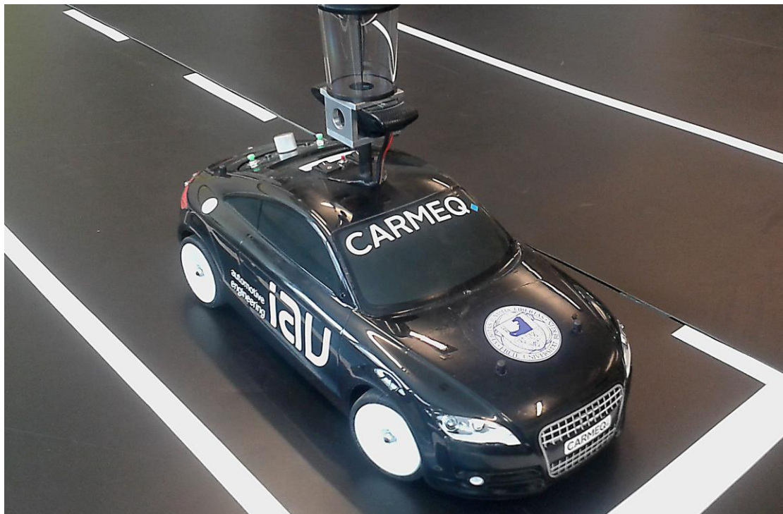
Abbildung 2.2: Fahrzeug mit Karosserie und montierter omnidirektionaler Kamera
