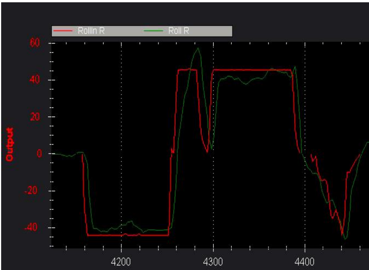
Abbildung 15: Das Rollverhalten des real existierenden Copters veranschaulicht wie bei den beiden simulierten Coptern, der rote Graph ist wieder die Eingabe durch den Bediener, der grüne Graph ist Reaktion des Copters auf die Eingabe, Einheiten entsprechen denen der Abbildung #12
