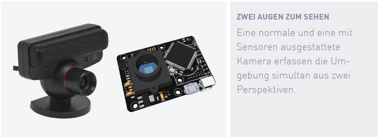
ABBILDUNG 10: SONY PS3EYE UND PX4FLOW SMART KAMERA
