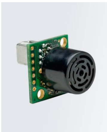
ABBILDUNG 7: SONAR MB1240 UND SONARHALTERUNG
