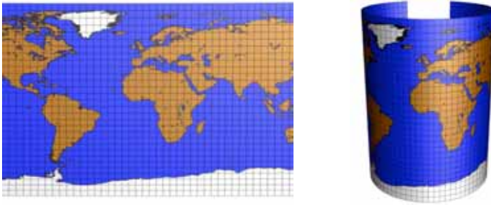
Abb. 5 Durch verzerrungsfreies Biegen kann ein planares Rechteck bijektiv auf einen geschlitzten Zylinder abgebildet werden, wobei Meßdaten wie Entfernung, Winkel und Flächeninhalt unverändert bleiben.
