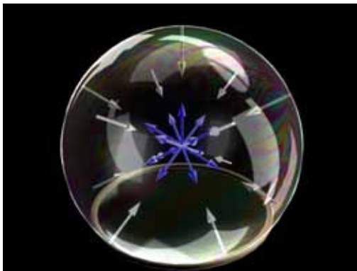
Abb. 8 Die Oberflächenspannung wirkt dem Gasdruck in der Seifenblase entgegen, und es herrscht Kräftegleichgewicht.
