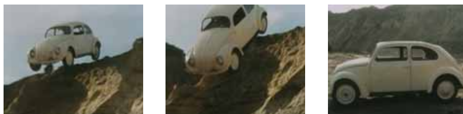
Abb. 4 Die Karosserie eines Volkswagen Käfer ist erstaunlich stabil. Das Bild rechts zeigt das Auto fast unversehrt nach einem vollen Überschlag.
